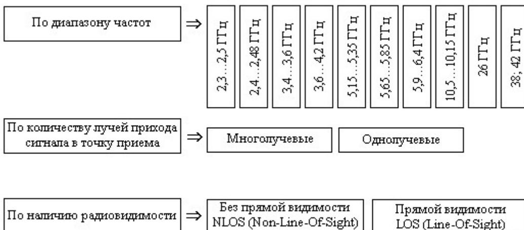
Рис. 3.17. Классификация радиоканалов
