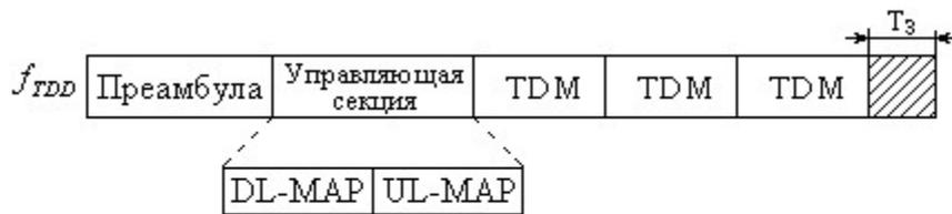
Рис. 3.20. Структура нисходящего канала.
