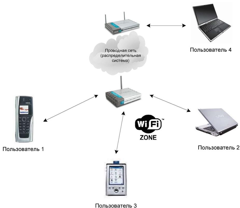
Рис. 3.7. Расширенная зона обслуживания ESS беспроводной локальной сети
